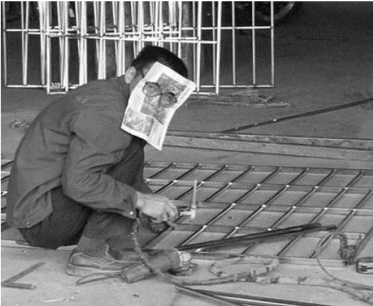
**¿Qué hay de malo en esta foto? Hay un obrero trabajando en la soldadura sin ningún tipo de EPP adecuado. Está utilizando un papel para protegerse la cara de la exposición al monóxido de carbono.**
