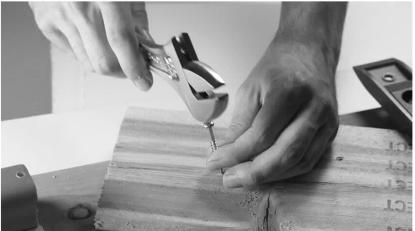
Sur l'image, une personne utilise une clé à molette pour enfonce une vis dans un morceau de bois tout en maintenant la vis en place avec ses doigts nus. Cette méthode est très dangereuse, car la clé n'est pas conçue pour cette tâche et la main du travailleur est dangereusement proche du point de contact. Cette méthode augmente le risque de glissement et de blessures graves à la main.
