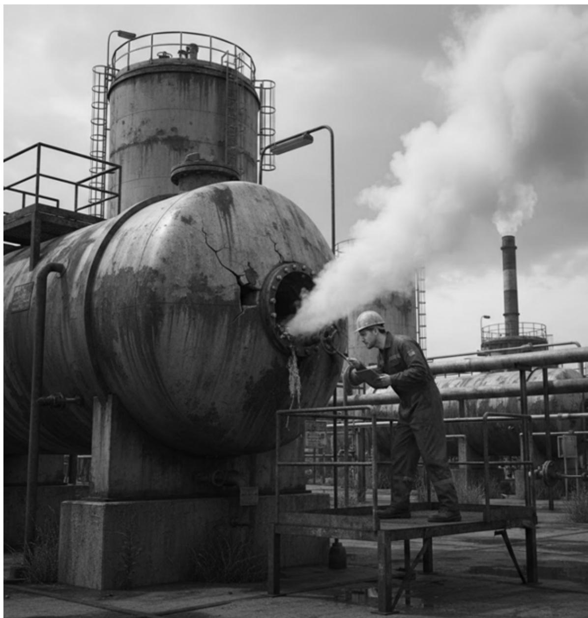
Sur l'image, le travailleur se tient juste devant un réservoir sous pression très endommagé qui laisse échapper de la vapeur par une ouverture fissurée. Au lieu d'évacuer les lieux, il se penche pour inspecter la fuite sans équipement de protection ni barrières. La surface corrodée du réservoir et les fissures structurelles visibles indiquent une négligence à long terme et un risque élevé de rupture. C'est précisément ce type de comportement dangereux qui a conduit à des
