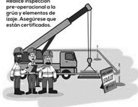
**3** Acordone y señalice el área del izaje de cargas, y extienda los estabilizadores al 100%. Utilice bloques de madera si es necesario.
