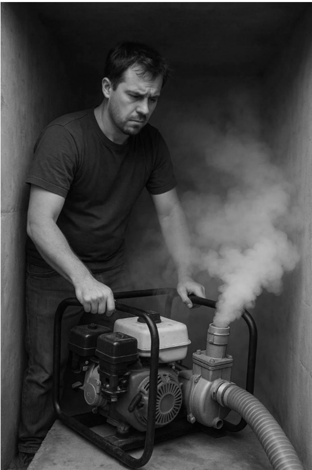
Esta imagen muestra a una persona manejando una máquina que funciona con combustible en un espacio pequeño y cerrado sin ventilación visible. La máquina emite gases de escape espesos que llenan rápidamente la zona. Esto crea un grave riesgo de intoxicación por monóxido de carbono, ya que los gases de escape de los motores de combustión interna contienen vapores tóxicos que pueden ser mortales cuando se inhalan en espacios cerrados.
