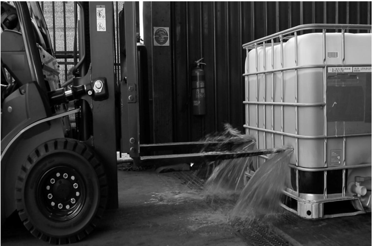
Cette image souligne l'importance cruciale d'effectuer des vérifications avant utilisation sur les chariots industriels motorisés tels que les chariots élévateurs. Ici, les fourches du chariot élévateur ont perforé un conteneur, provoquant un déversement important de matières dangereuses. Cet incident pourrait entraîner une contamination de l'environnement, des blessures pour les travailleurs, voire un incendie si la substance est inflammable.
