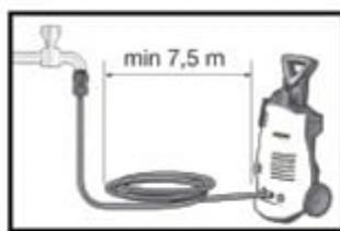
Utilice como mínimo 7,5 mts. de manguera de entrada de agua. Se prolongará la vida útil de la máquina.
