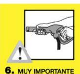
Al finalizar el uso, apague el motor, cierre el grifo y presione el gatillo para eliminar la presión en la bomba. RECUERDE, CON EL MOTOR APAGADO!
