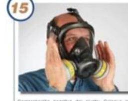
Comprobación negativa del ajuste. Coloque las palmas de las manos sobre los dos cartuchos o tapas de máscara para que queden completamente sellados, e inhale. Retenga la respiración durante 5 segundos. Si el sellado es bueno, la máscara debe retraerse hacia su rostro.
