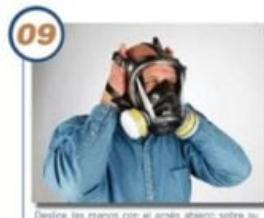
Deslice las manos con el armazón abierto sobre su cabeza hasta que la máscara esté cerrada y cuidando que el cabello no interfiera con el sellado. No ajustar todavía.
