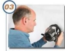
Retire el lente para asegurarse de que no esté quebrado ni muestre signos de agrietamiento.
