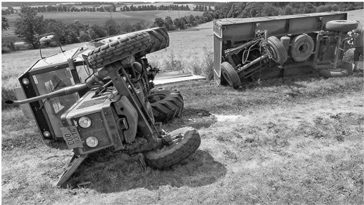
Le renversement du tracteur et de la remorque suggère une défaillance de l'attelage ou un mauvais équilibre de la charge pendant le fonctionnement. Cela indique que l'attelage n'était pas correctement fixé ou que le terrain et la pente n'avaient pas été correctement évalués au préalable. De tels incidents de renversement présentent des risques graves de blessures ou de décès pour l'opérateur et d'endommagement de l'équipement.
