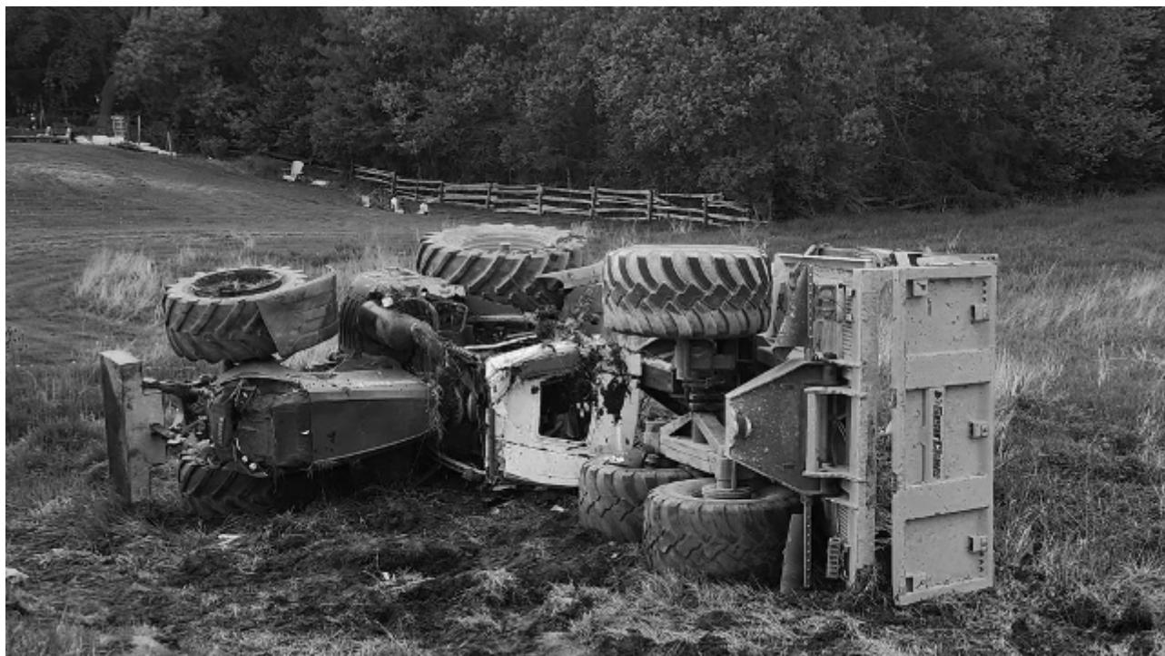
El tractor volcado y el implemento acoplado sugieren prácticas inseguras de remolque o enganche, probablemente debido a una configuración inadecuada de la cadena de remolque o del punto de enganche. Cuando las cadenas se conectan demasiado alto o a piezas inestables, el riesgo de vuelco aumenta drásticamente, especialmente en terrenos irregulares o blandos.
